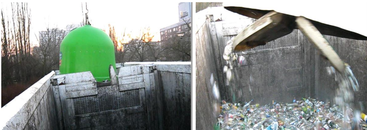
Abbildung 6: Zweikammerfahrzeug KM – Leerung DC Grünglas (links), Leerung DC Weißglas (rechts) (04.03.2014)
